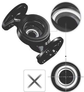
Рис. 17 Неправильно выровненная система уплотнений
