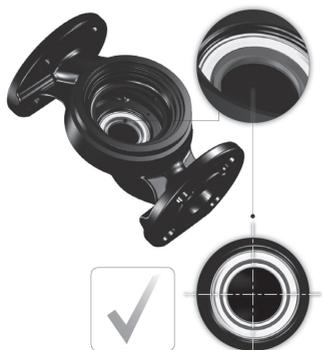
Рис. 16 Правильно выровненная система уплотнений
