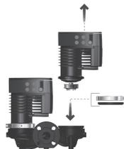
Рис. 37 Установка глухого фланца
